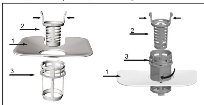
Система фильтров состоит из плоского стального фильтра, а также из фильтров грубой и тонкой очистки.
