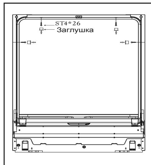
1. Закрепите посудомоечную машину в нише шкафа с помощью 4-х саморезов ST4x26, как показано на рисунке.
