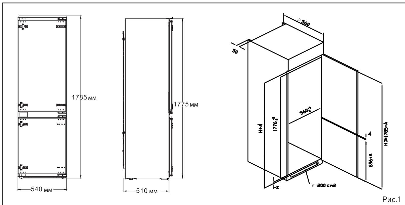
2. Вставьте холодильник в нишу не до конца. Выдвиньте до упора ограничители из опор холодильника и поверните их длинной стороной вниз, после чего задвиньте холодильник в шкаф так, чтобы они зацепились за передний край дна шкафа. Зафиксируйте глубину установки прибора. Передний край верхнего козырька должен при этом наложиться на верхний край шкафа.
