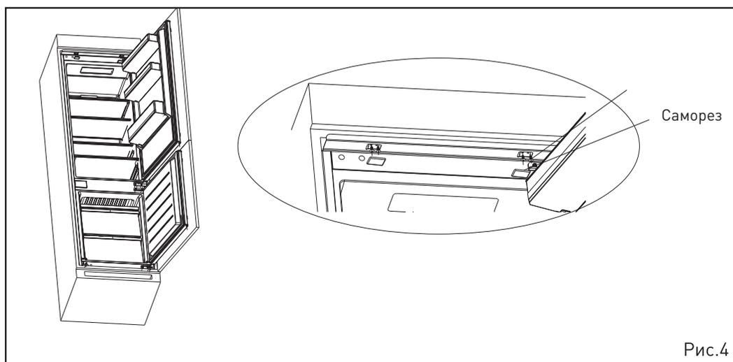
5. Откройте нижний фасад до максимального угла, затем откройте нижнюю дверцу холодильника и совместите их. Выдвиньте верхний и нижний кронштейн двери, убедитесь, что внутренний край совпадает с нижним краем дверцы холодильника, затем закрепите их на дверце шкафа саморезом и установите заглушки. Аналогичным образом прикрепите верхнюю дверь холодильника к двери шкафа.
