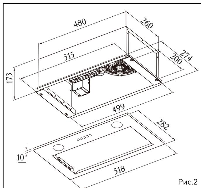
3. Ознакомьтесь со сборочным чертежом в разрезе для оптимальной установки вытяжки в кухонном пространстве, в мм.
