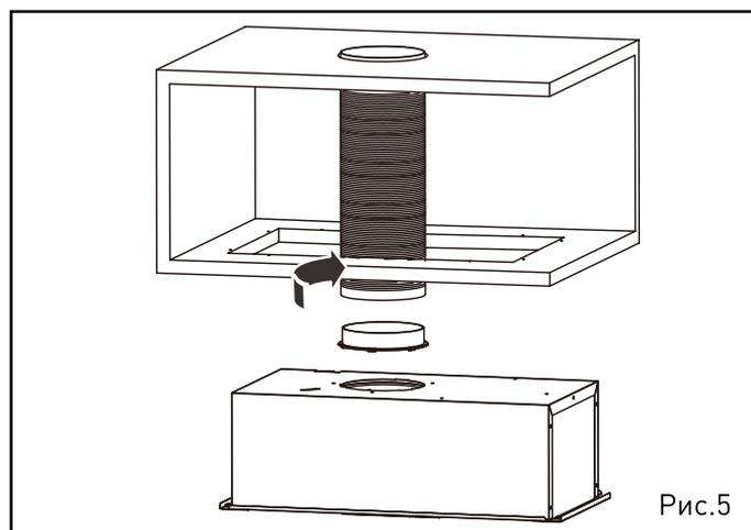
6. Установите вытяжку в нишу шкафа и закрепите ее саморезами.
