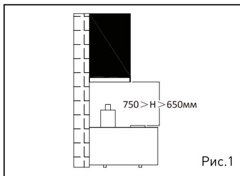
2. Перед установкой прибора примите во внимание габаритные размеры прибора, в мм.
